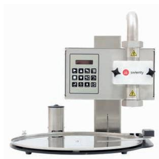
**Dosatrice elettronica con caricatore rotante** è abbinata ad un tavolo rotante Ø 45, con pompa ad ingranaggi e riduttore elicoidale. Dispone di 20 programmi di riempimento. La macchina funziona in entrambe le direzioni e può essere impostata su velocità diverse.
