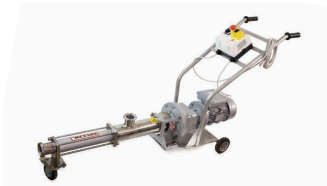
**Pompa monovite** per miele con corpo in acciaio inox, girante G90 in neoprene e motore monofase. Velocità di rotazione lenta (195 giri/min) in entrambi i sensi.
