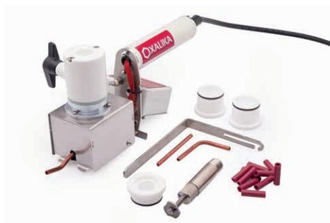
**Sublimatore Oxalika PRO Power** per uso professionale. Con una potenza di 600 Watt è il modello Oxalika più veloce e potente. Dotato di controllo di temperatura, riesce a sublimare 10 grammi di acido ossalico ogni 60 secondi e 2 grammi di acido ossalico ogni 12 secondi. Valvola Smart e dosatore a stantuffo Sprint compresi.
