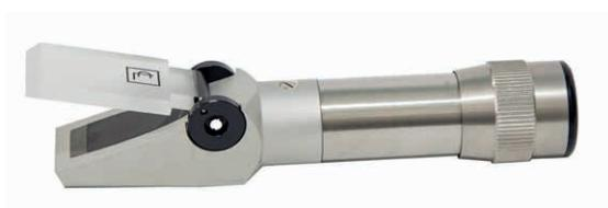
**Rifrattometro Monoprismatico** per uso professionale. Utile per determinare il livello di umidità del miele.
